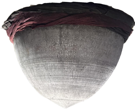
Fig. A1: Bata (Condenser)
