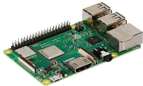
FIGURE A. 2 RASPBERRY PI MODULE
