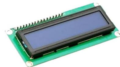
LCD Display Module 16x2
