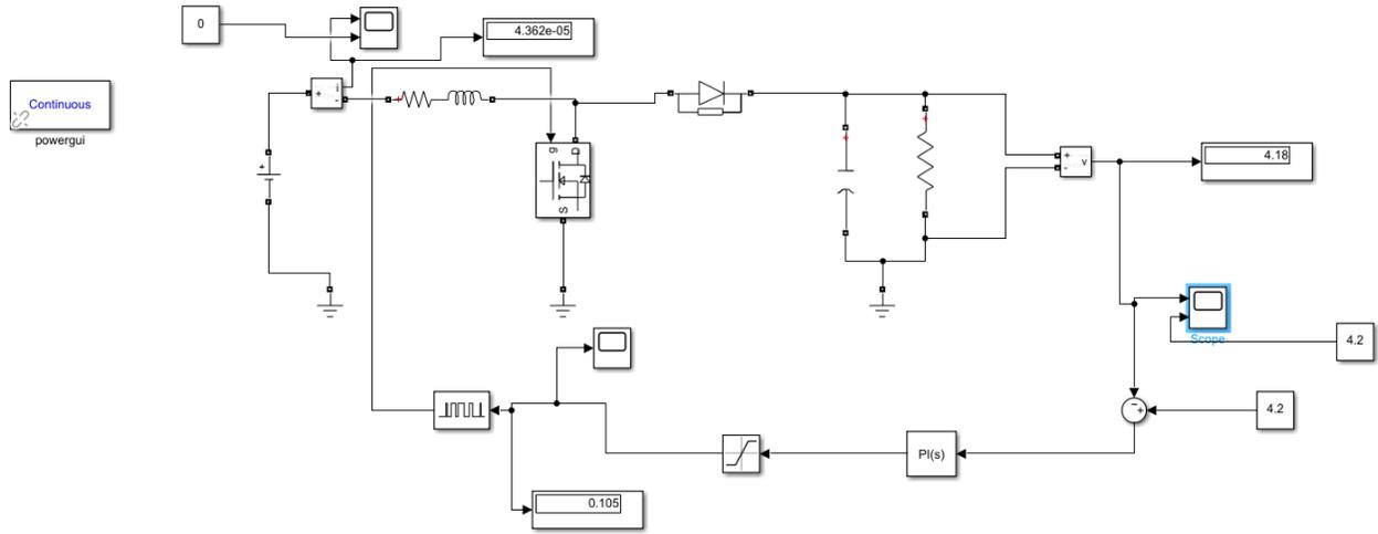
**FIGURE 4. 12 BOOST CONVERTER CIRCUIT**
